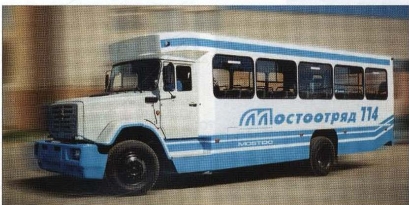
На машине установлен независимый жидкостный подогреватель двигателя и салона мощностью 23 кВт российского производства. По заказу можно установить подогреватель Webasto 35 кВт.
