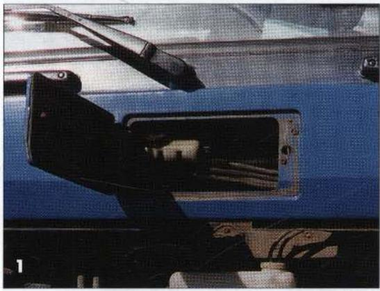
1. Резервуар для гидравлической жидкости
