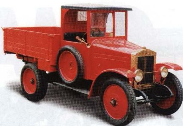
увеличить мощность двигателя. Поверхность охлаждения радиатора доведена до 11,5 м<sup>2</sup> (на 3 м больше, чем у «фиата»), что предотвратило закипание воды в сильную жару и на затяжных подъемах. Уменьшение на 80 мм диаметра маховика увеличило дорожный просвет, улучшило проходимость автомобиля. «AMO-Ф15» обладал редкими для тогдашних грузовиков электрическими фарами, пневматическими шинами, карданной пе-
