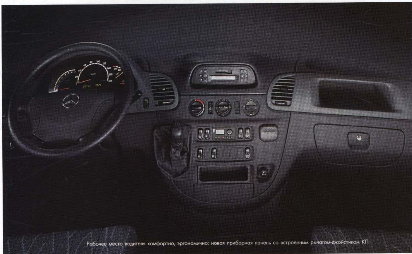
Рабочее место водителя комфортно, эргономично: новая приборная панель со встроенным рычагом-джойстиком КП
