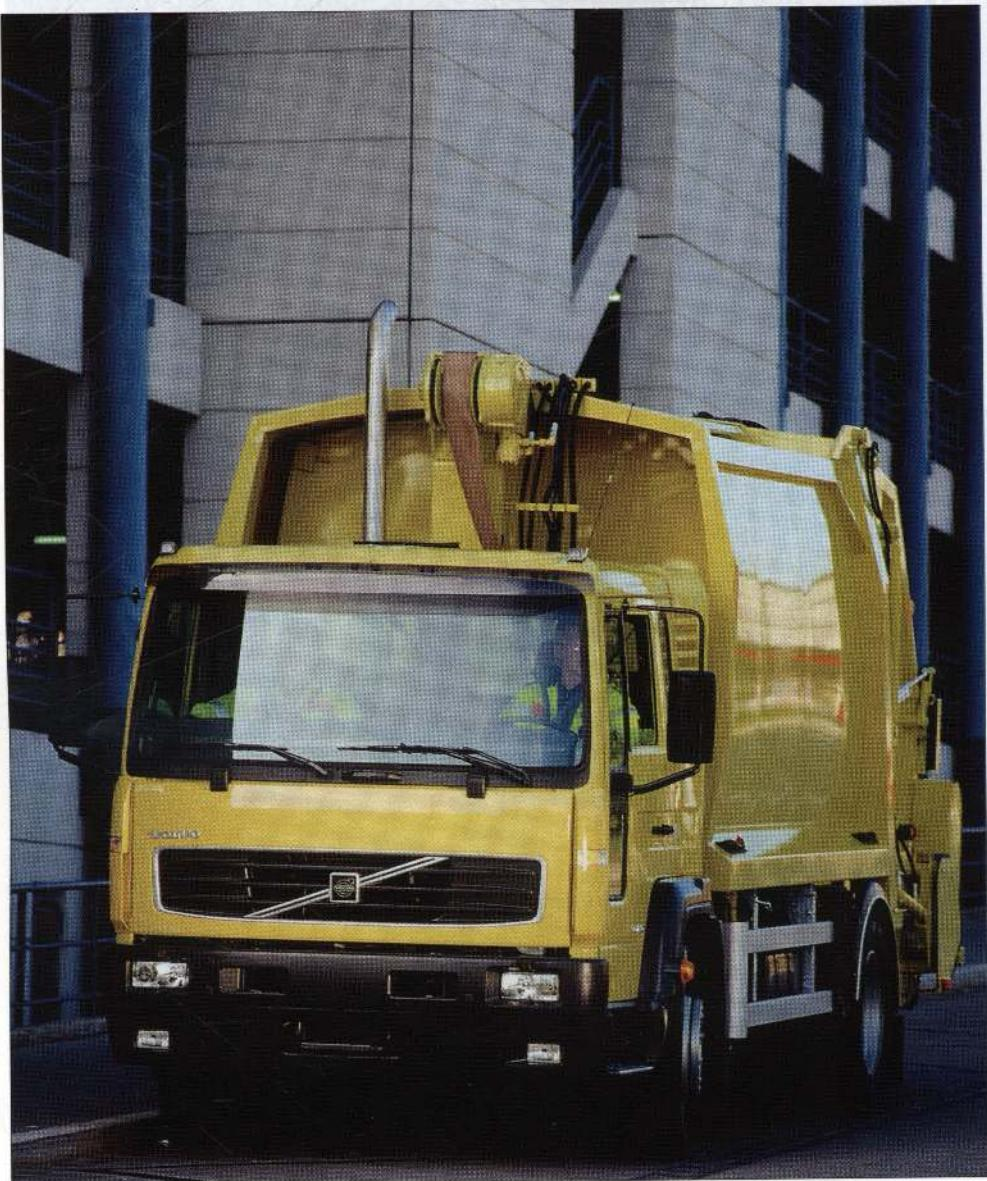
Полная масса Volvo FL6 от 7,5 до 26 т. Грузовик может комплектоваться шестью типами коробок передач с ручным управлением и тремя типами автоматических коробок передач. Интервал между обслуживанием увеличен до 40 000 км или раз в полгода.
